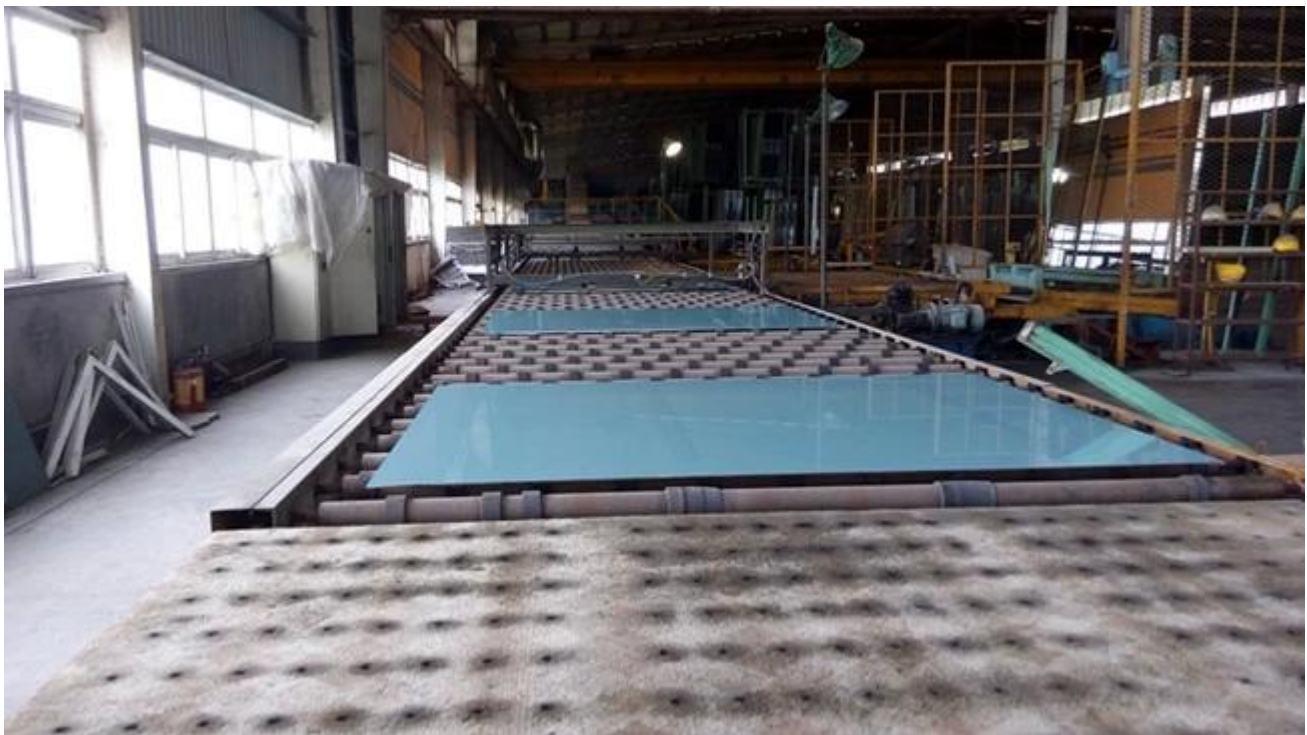
Línea de producción de vidrio de espejo
