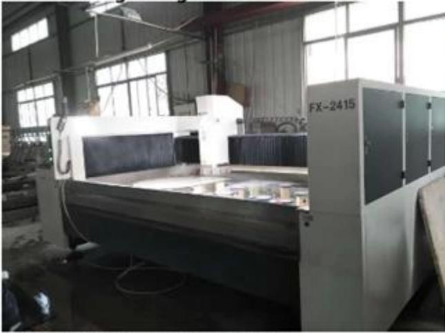
CNC Edge grinding machine CNC磨边机
