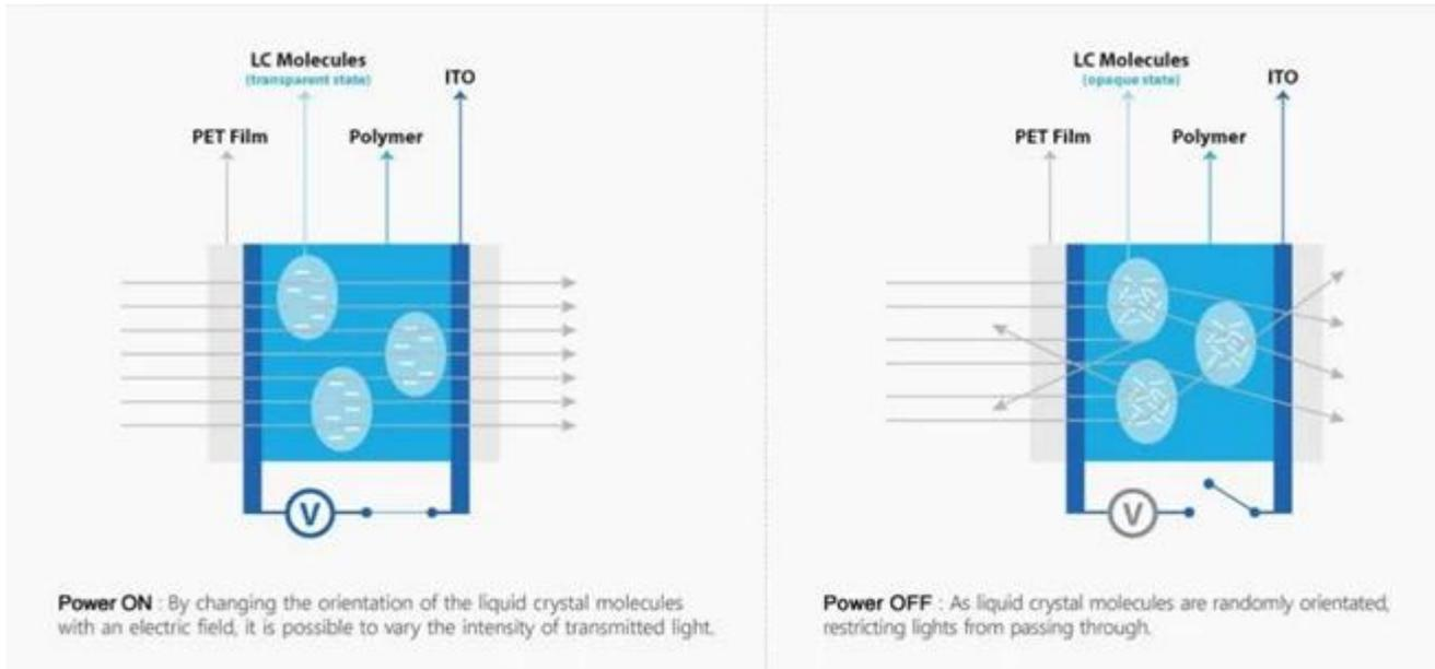
المتحكم إلكترونيًا بشكل غير منتظم. في led الموجودة في الزجاج الذكي LCD عند إيقاف تشغيل الزجاج السحري ، ستظهر جزيئات الداخلية ، LCD نفاذية الضوء ولكن غامض. عند تشغيل الزجاج السحري ، تتراكم جزيئات PDLC هذا الوقت ، سيكون زجاج فيلم ويمكن للضوء النفاذية بحرية ، والزجاج الذكي شفاف. طريقة التحكم في الزجاج السحري: العمل اليدوي ، والتبديل عن بعد أو وفقا لمتطلبات العملاء
