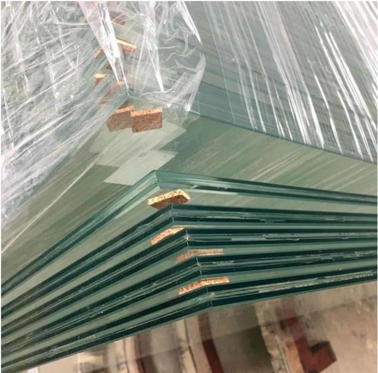
**Fertigungslinie für 13,52 mm klares, laminiertes gehärtetes Glas**
