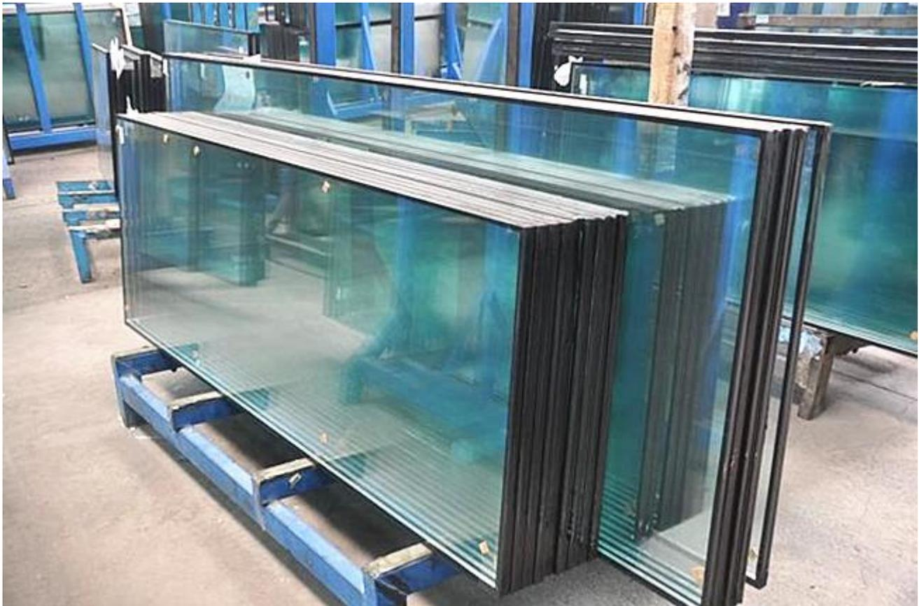
**Gehärtetes, isoliertes Glas für die Vorhangfassade:**
