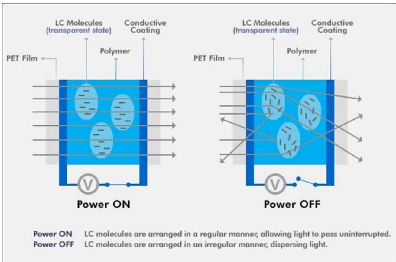
Elektrische Privatsphäre Glasboden uns auf den Gehwegen, wWenn Sie den PDLC-Film einschalten, wird er transparent und wirkt gefährlich. Beim Ausschalten ist es opalfarben und sieht aus wie das normale Sicherheitsglas Fußboden.
