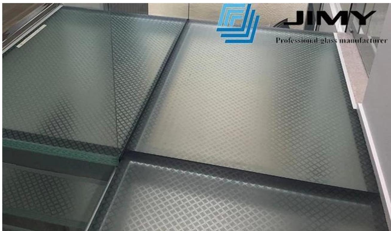
El vidrio de piso antideslizante de 39.04 mm está compuesto por 3 capas de 12mm vidrio templado permanentemente unidos con 2 enterrar capas de película PVB / SGP de 1.52 mm a través de un control led, proceso de calentamiento altamente presurizado e industrial. El proceso de laminación hace que los paneles de vidrio se mantengan unidos en caso de rotura reduciendo el riesgo de daño.
