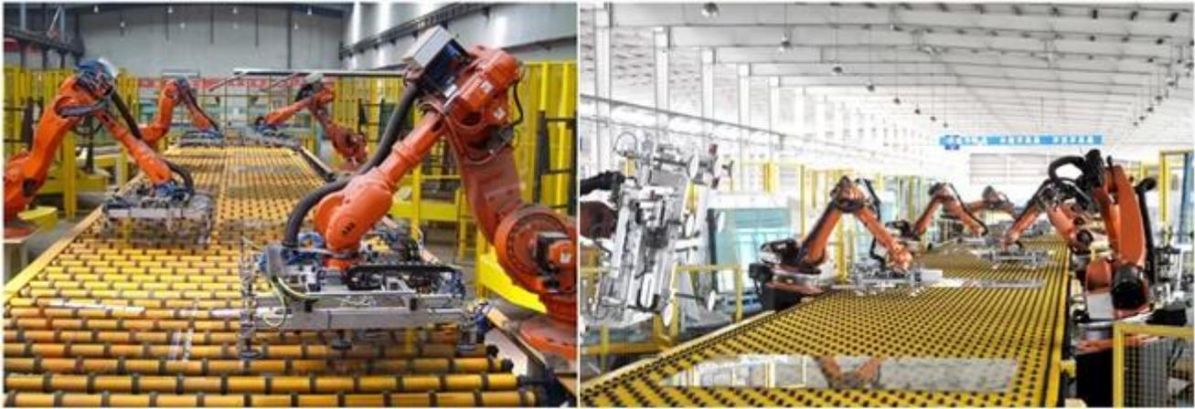
**Carga de seguridad vidrio de flotador**
