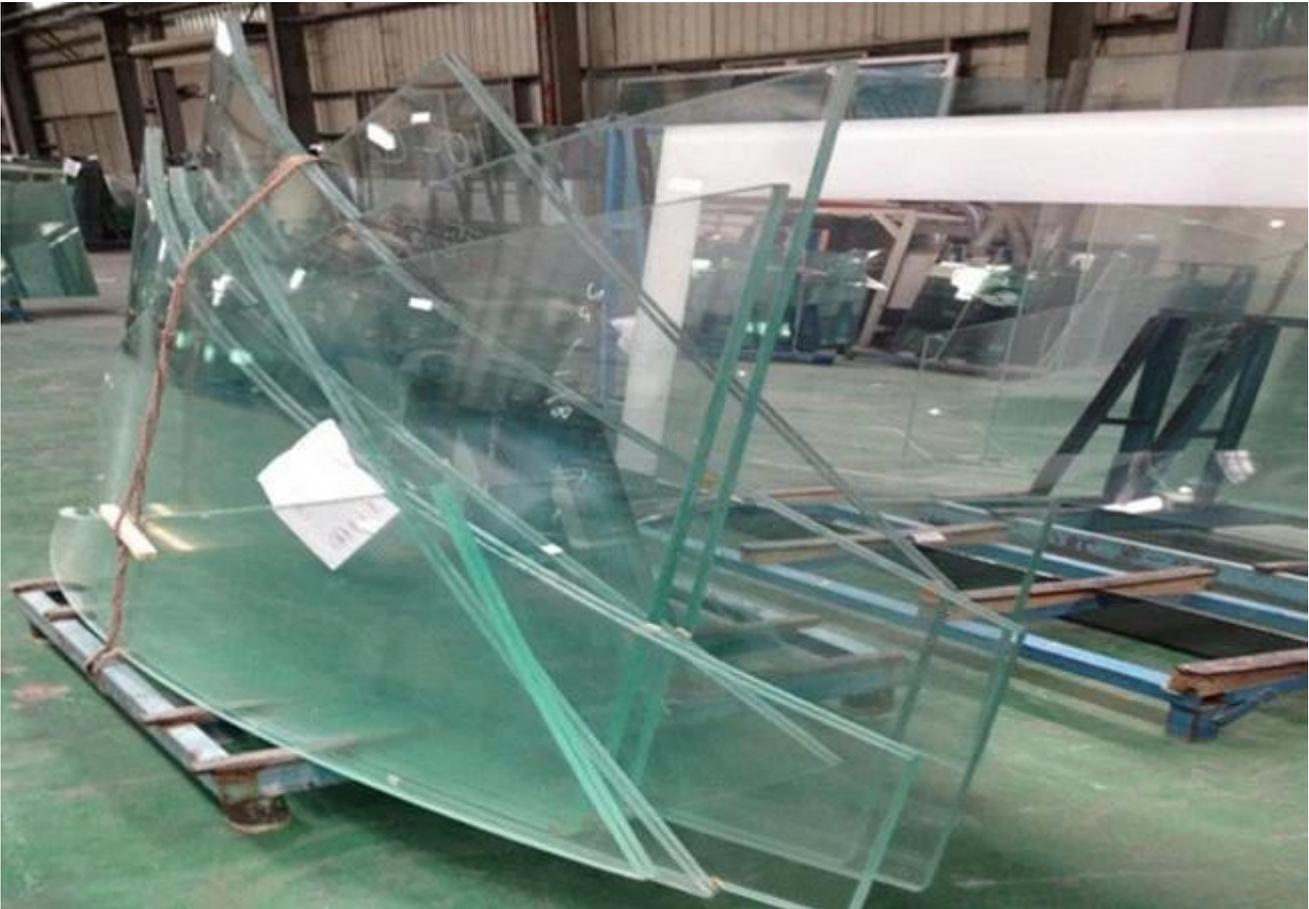
**Plataforma de vuelco inspección de la Vidrio curvado de ESG:**
