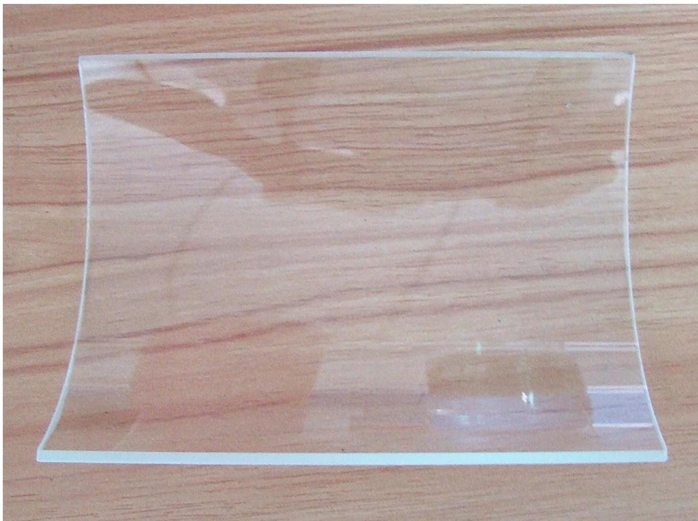
**Comparar el vidrio de flotador de baja en hierro y vidrio de flotador claro-más claro borde, sin el tinte verde del vidrio de flotador estándar**
