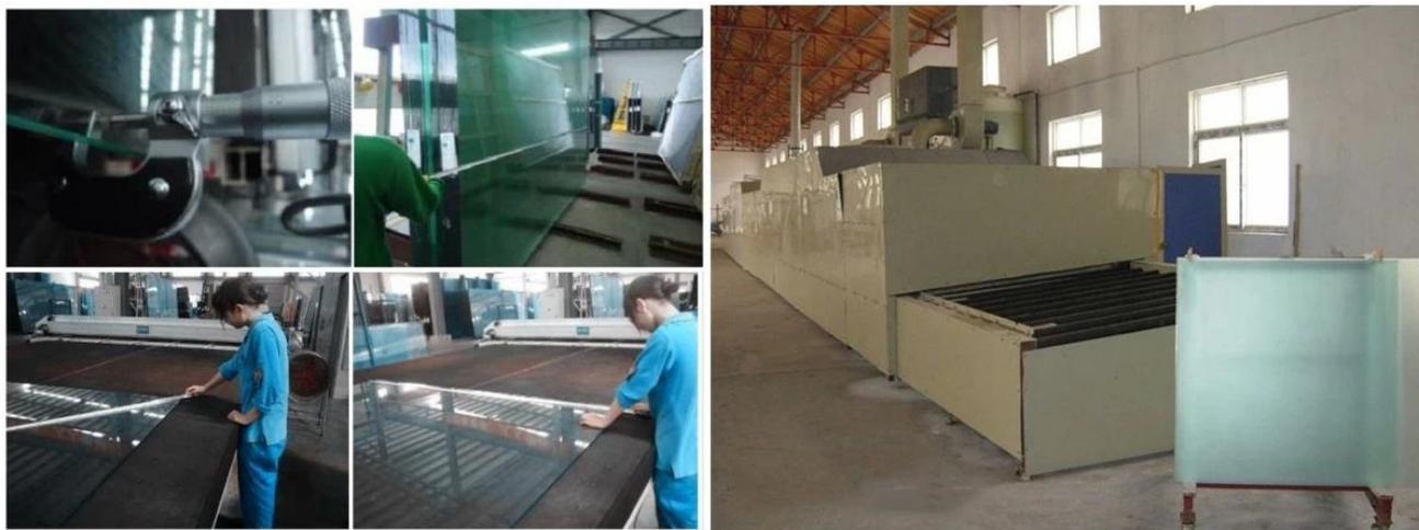
2. Utilice un instrumento de prueba profesional para inspeccionar la presión de vidrio templado, y si tiene impurezas, asegúrese de que su tasa de autoexpansión sea inferior al estándar de la industria
