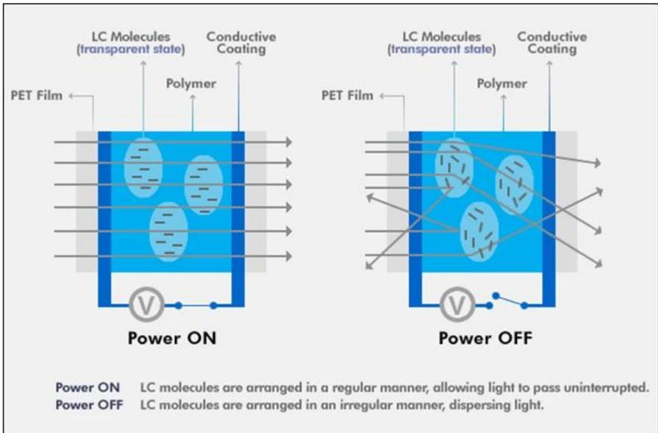
Piso de vidrio de privacidad eléctrica nosotros en los pasillos, wCuando enciende la película PDLC, se vuelve transparente y parece peligrosa; cuando se apaga, es de color opal y parece el vidrio de seguridad normal piso.
