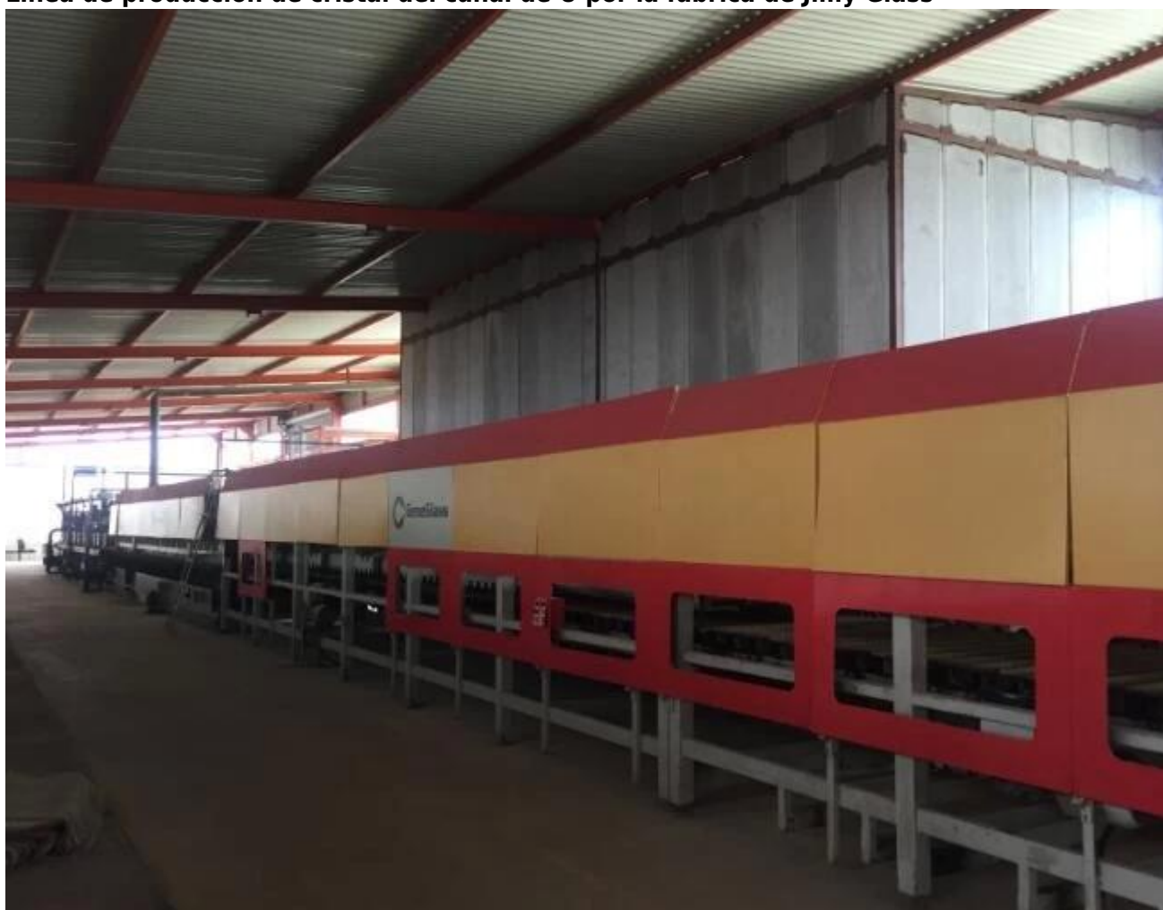
Línea de producción de cristal del canal de U por la fábrica de Jimmy Glass
