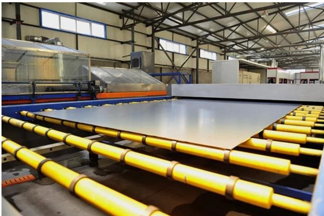
Ligne de Production de verre miroir
