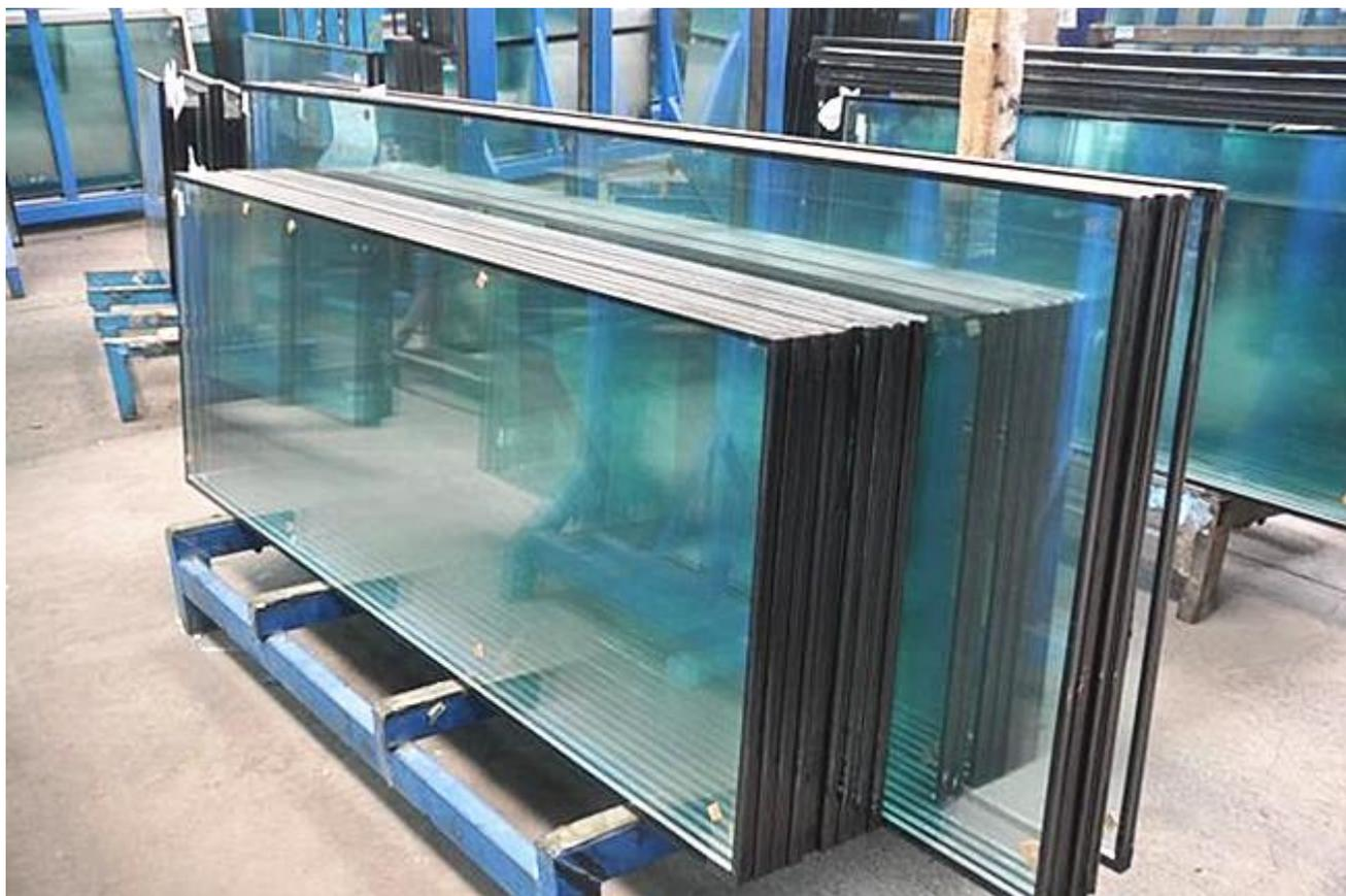
**Verre isolant laminé tempéré utilisé pour le mur-rideau:**
