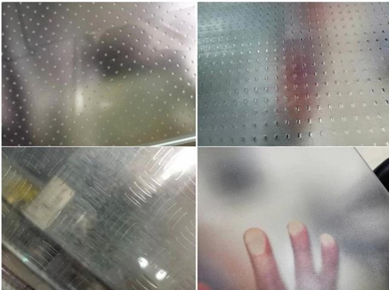
**Vue des panneaux de sol en verre trempé stratifié gravé à l'acide SGP extra clair de 48 mm**
