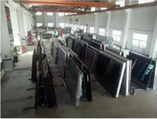
2. 玻璃板在玻璃厂内经过切割、磨边、钢化等工序，最后由叉车运送到仓库。
