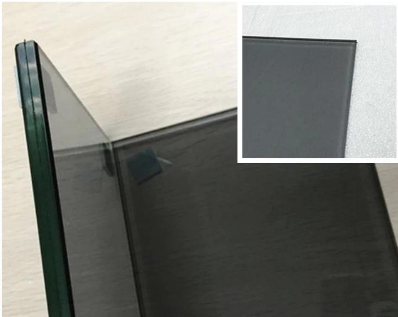
**Aplicação de vidro laminado cinza de 10,38 mm de espessura:**
