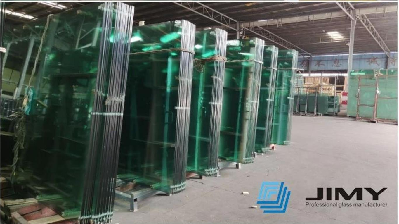
5. Pacotes de segurança para vidro temperado de 12 mm, use caixas de madeira compensada novas para embalagem, com rolas para vidro separado sem colisão.
