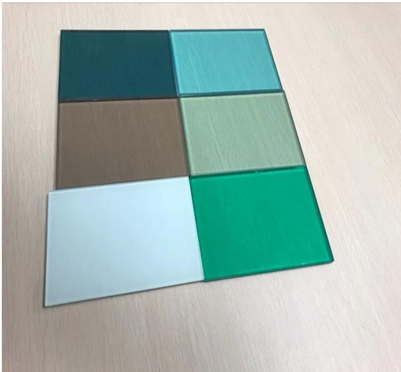
Aplicação de vidro de segurança laminado PVB PV de 6,88 mm
