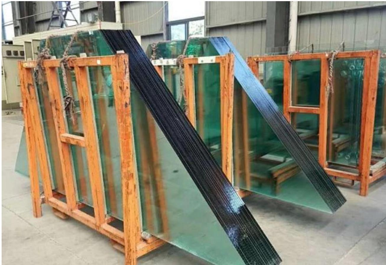
**O produto de vidro acabado depois de desossada de uma camada de filme cinza PVB / SGP, é um painel de vidro laminado temperado com formato especial, conforme abaixo:**
