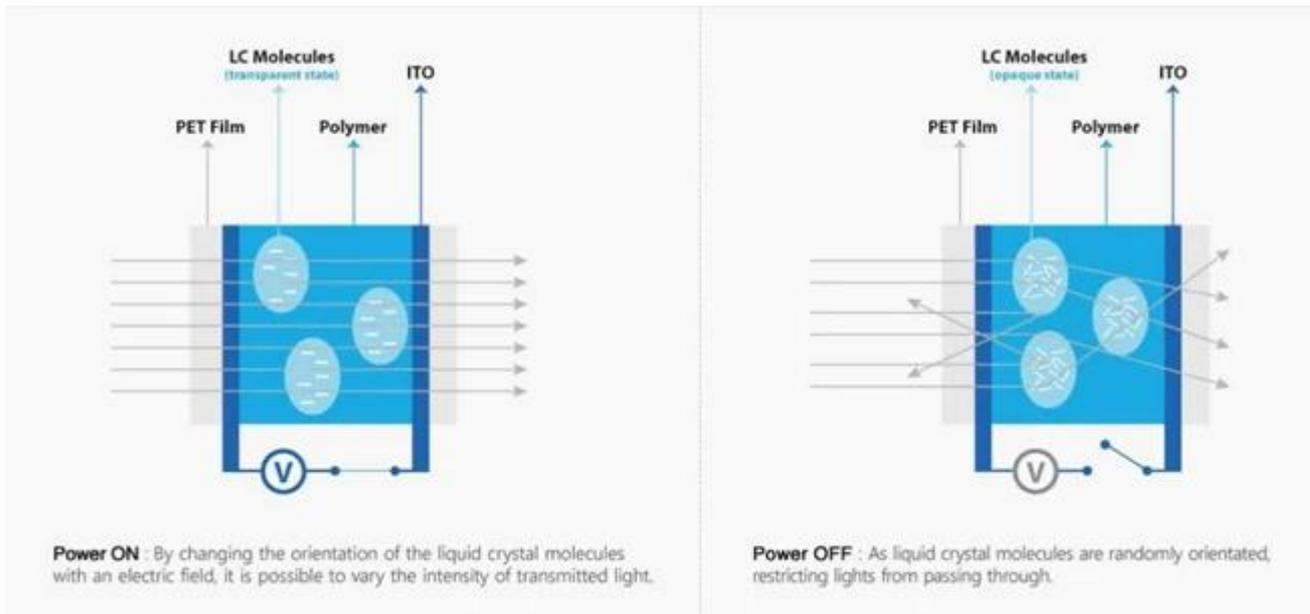
Quando o vidro mágico é desligado, as moléculas de LCD no vidro inteligente de controle eletrônico led aparecem irregularmente dispersas. Neste momento, o vidro de filme PDLC será transmitido pela aparência, mas opaco. Quando o vidro mágico foi ligado, as moléculas de LCD internas estão se acumulando e a luz pode transmitir livremente, o vidro inteligente é transparente. O método de controle do vidro mágico: trabalho manual, interruptor remoto ou de acordo com os requisitos do cliente
