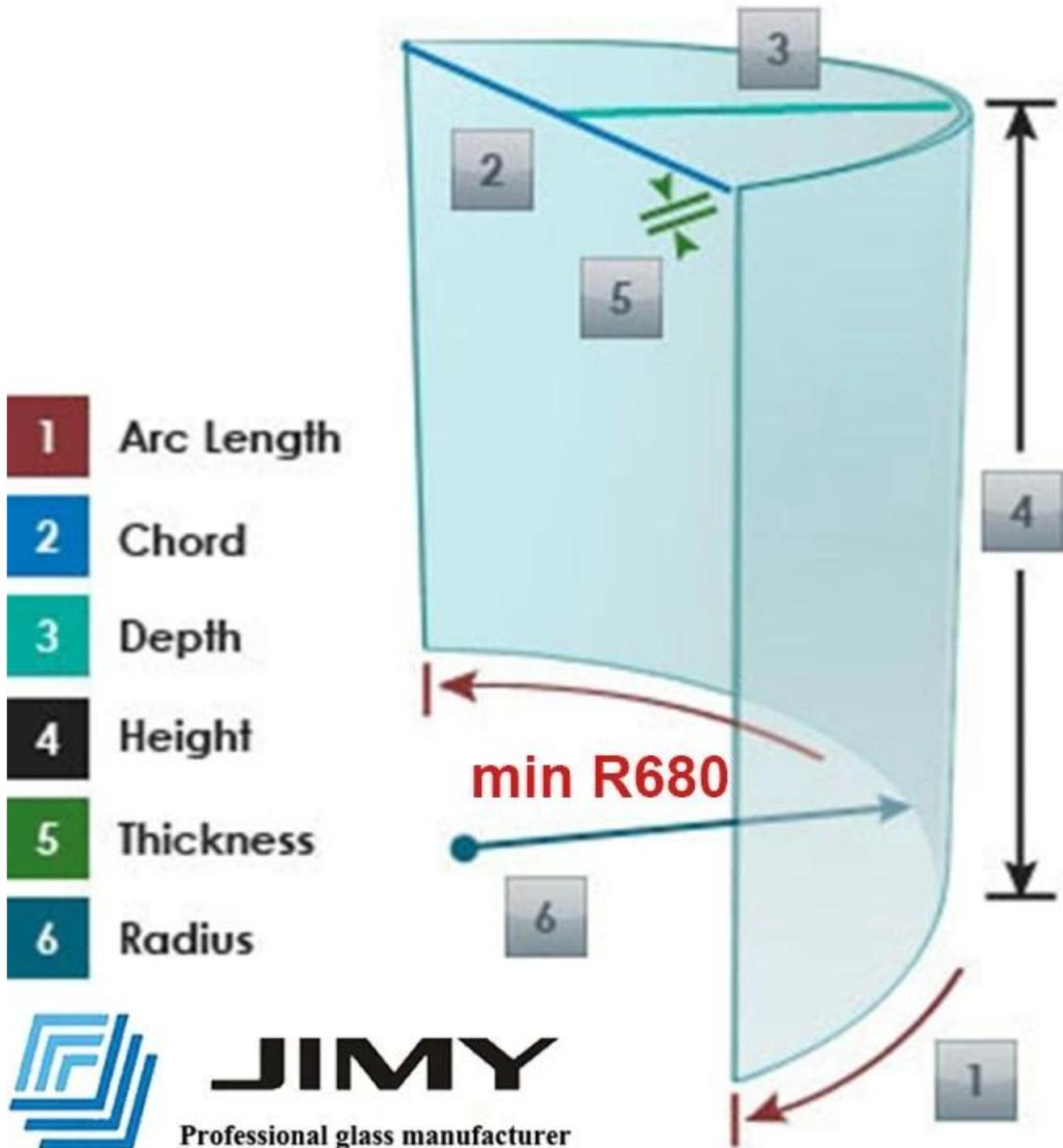
O vidro laminado temperado curvo de 6 + 6mm é feito de duas camadas de vidro temperado curvo de 6mm ligado com um interlayer (PVB / SGP) através de um controle led, altamente processo de aquecimento pressurizado e industrial.
