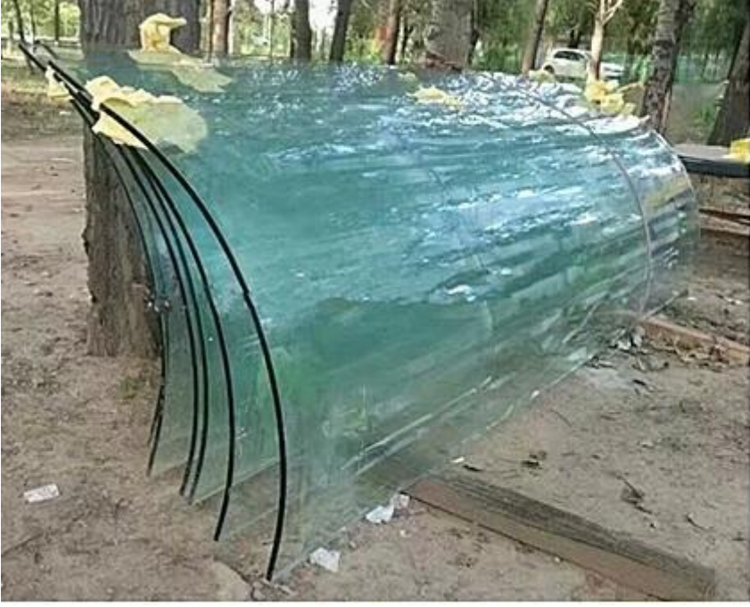
Küpeşte için 10 mm net kavisli temperli cam.
