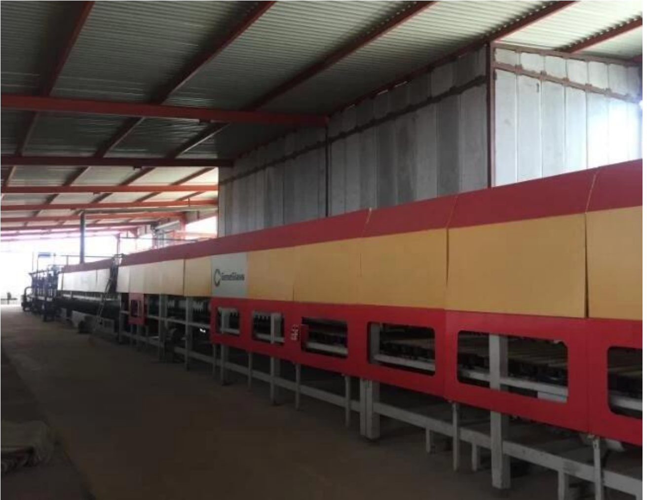
Jimy Glass Fabrika tarafından U kanal cam üretim hattı
